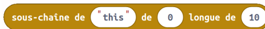
Récupère une partie de chaîne à partir d'un caractère et d'une taille donnée
