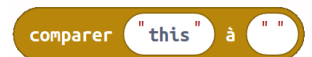
Compare deux chaînes de caractères dans l'ordre alphabétique et renvoi 1, 0 ou -1 en fonction du classement
